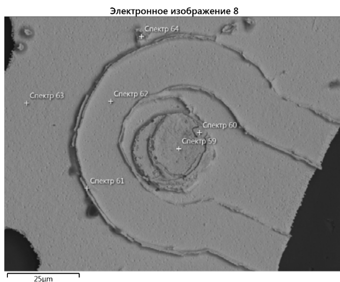
Рис. 6. РЭМ-изображение поверхности контакта (подвижной контакт-детали) МЭМС, забракованного по электрическому сопротивлению ( R_{cm} > N ). Область анализа 59 имеет диаметр около 1 мкм
