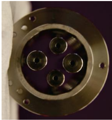
Рис. 8. Фотография электродов КФМ, формирующих 12-процентную гексапольную компоненту ( A_3 = 0,12 ); r_0 = 4,5 мм, \theta = 7,69^\circ , r_x = 5,9378 мм, r_y = 5,1692 мм [32]
