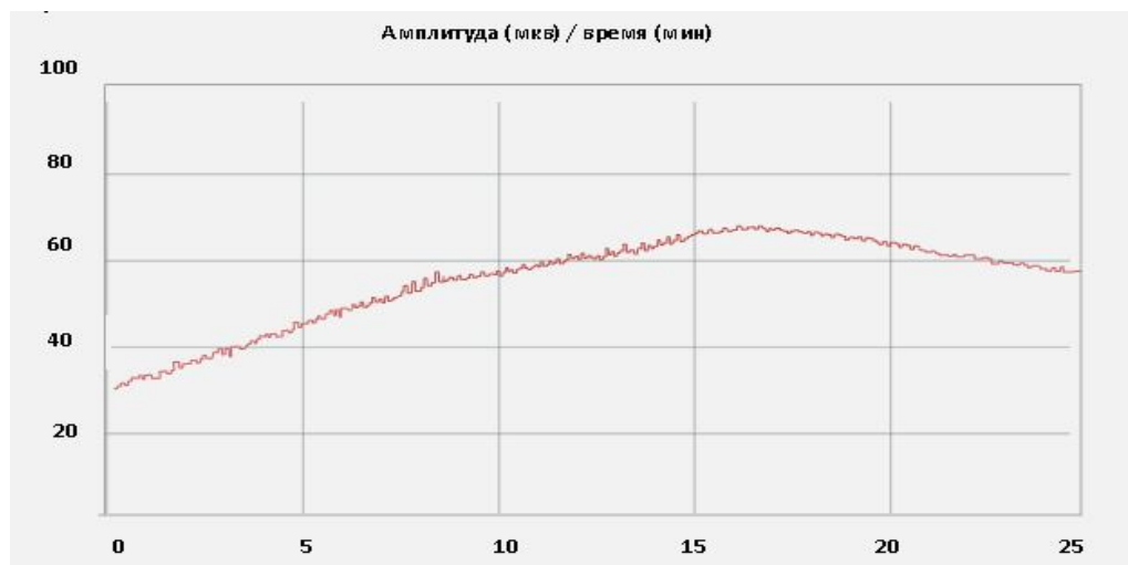
Рис. 11. Зависимость амплитуды акустических импульсов от времени приработки
