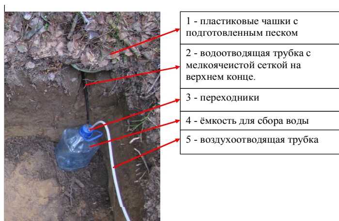
Рис. 5. Установка для сбора лизиметрических вод
