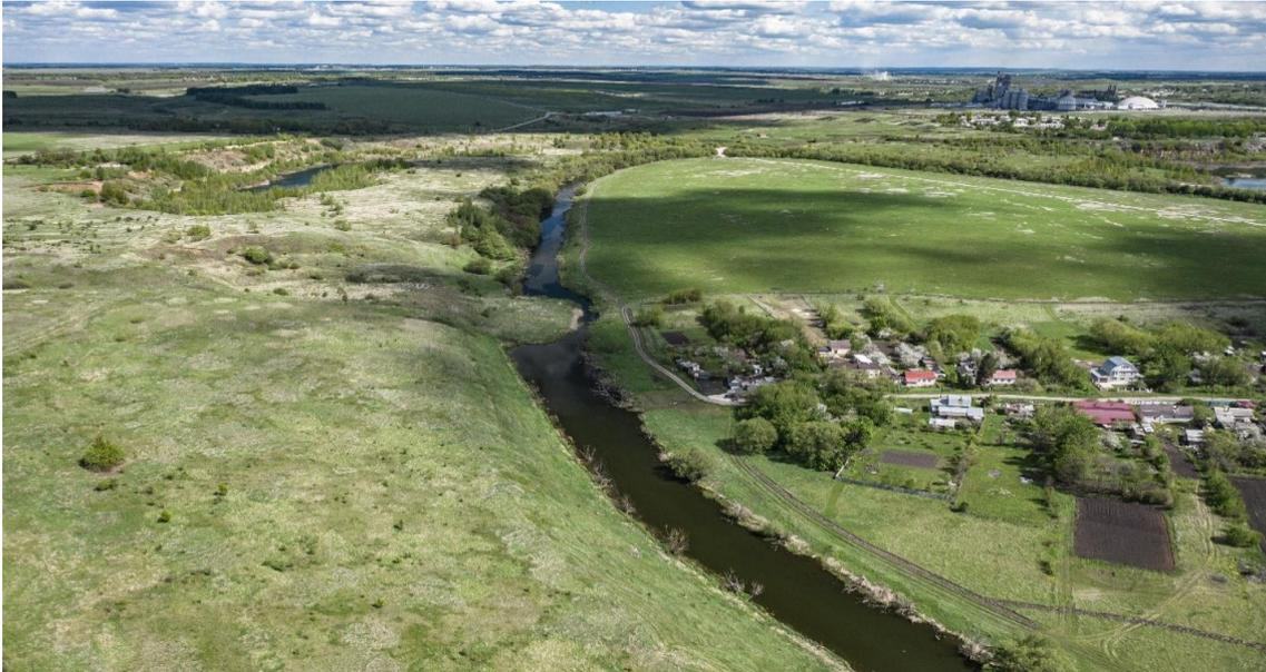
Рис. 5. Оползень, сошедший с левого борта долины реки Прони и образовавший плотину в русле реки (напротив северной оконечности деревни Серебрянь)
